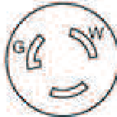
Interconnecting receptacle : NEMA L5 -15 R
